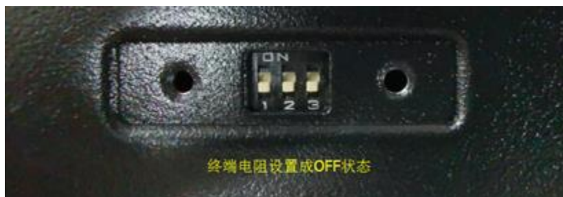
图 2.2 拨码开关使用方法
