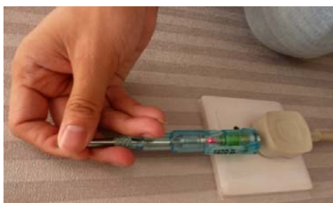
不用拔下插头可以测插座是否有电
