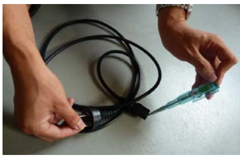
灯不亮—电脑电源线有断路
