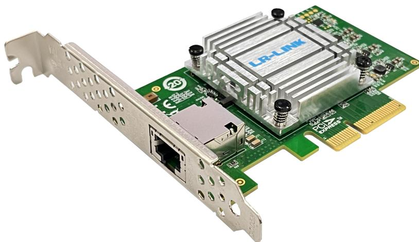
LRES2051PT 是深圳市联瑞电子有限公司在 Marvell AQC113 主控方案基础上开发的一款 PCI Express v4.0 x4 单电口 10G 以太网网络适配器。该款适配器可以同时兼容 PCIe x8、x16 通道。是一款高性能的六速率适配器，可为客户端系统提供电源和空间高效连接的同时 PCIe v3.0 x4 的通用接口使该款产品具有更好的灵活性。
