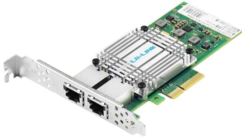
LREC9812BT 是深圳市联瑞电子有限公司基于 Intel X550 方案基础上自主研发的一款 PCI Express x4 双电口万兆以太网服务器适配器，同时兼容 PCI Express x4、x16 插槽，该款服务器适配卡适合于服务器和高端网络设备使用的同时也适用于普通工作站使用；该款适配卡在开发设计同时对其性能进行了优化改进，使系统 I/O 不再是网络应用的瓶颈。该款适配卡能够通过捆绑汇聚成组实现容错，自动检测并实现将来自故障端口的通信路由至同组中其他成员继续运行以实现不间断通信。该款适配卡具有集成的硬件加速功能，能够执行 TCP/UDP/IP 校验和分载及 TCP 分段任务。主机处理技术可分载加速器，主机处理技术可分载加速器，释放 CPU 资源的占用，以腾出更多的 CPU 资源来处理其他应用程序。
