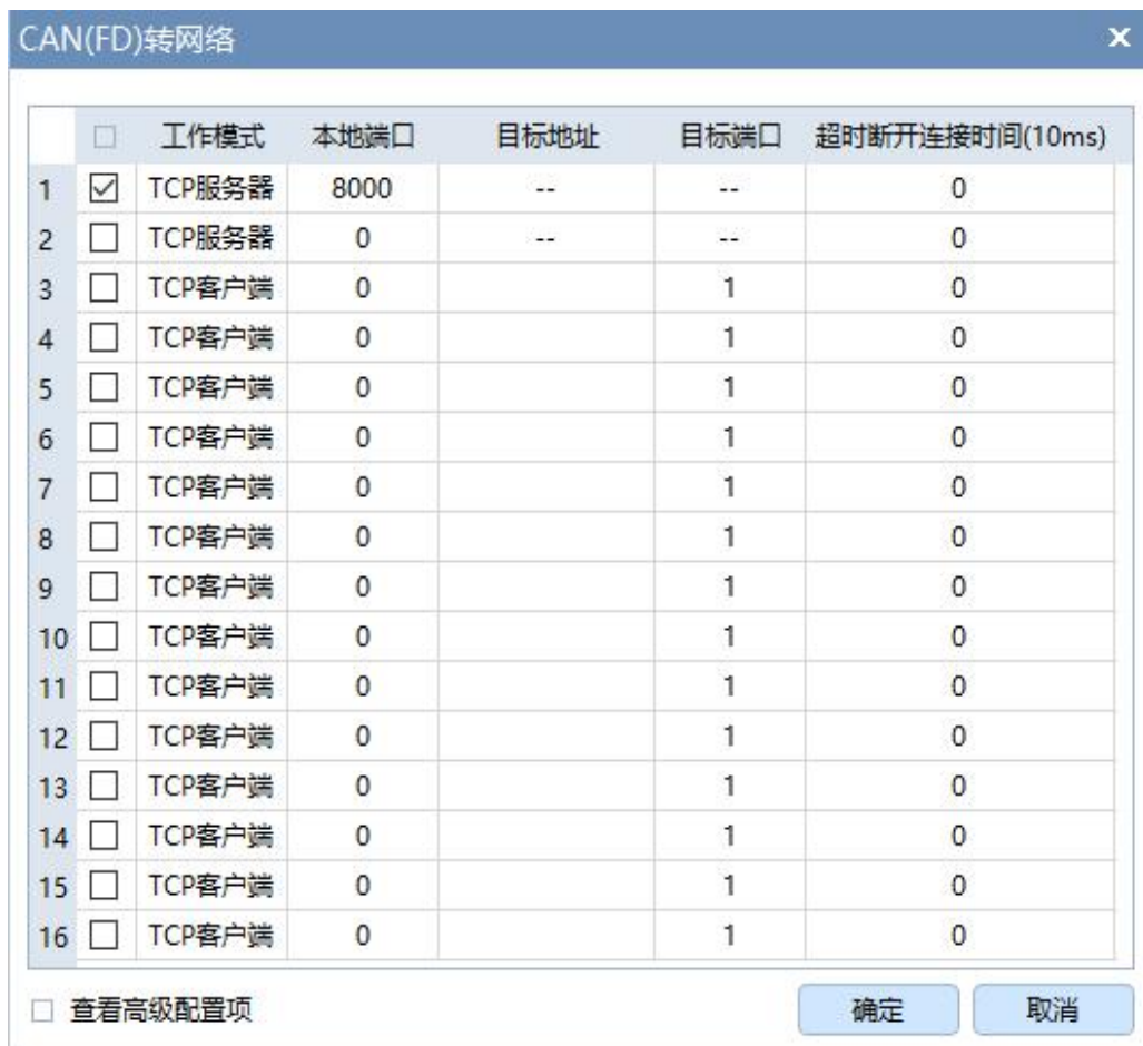
图 5.7 “CAN(FD)转以太网”配置界面
