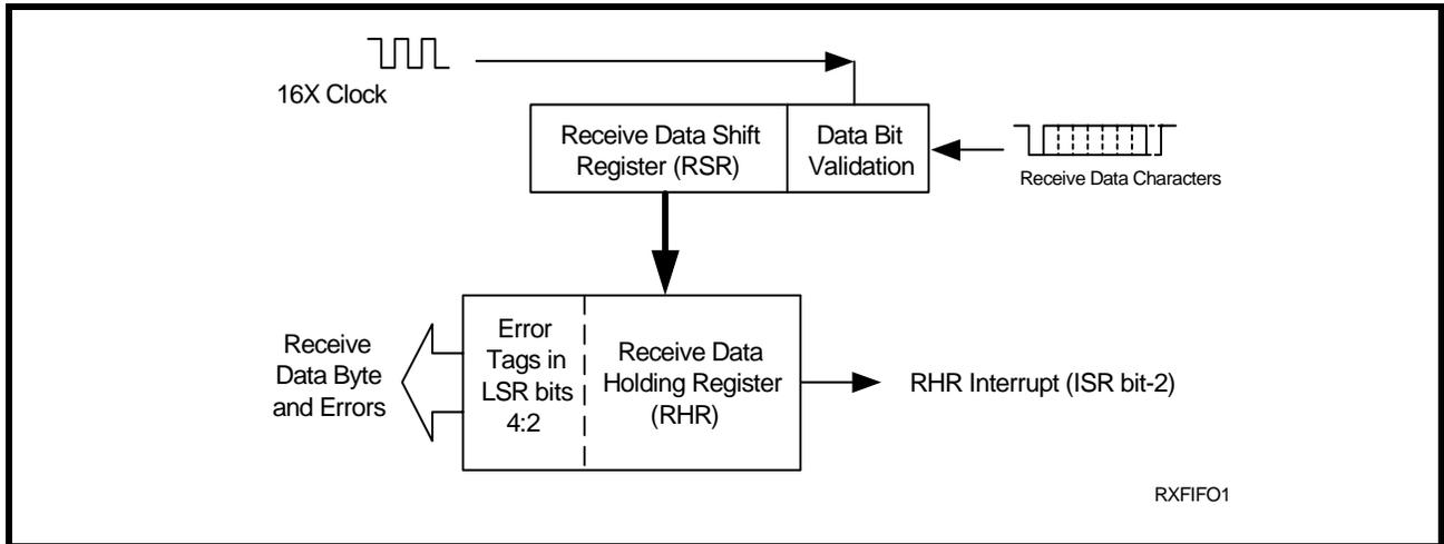
**FIGURE 9. RECEIVER OPERATION IN FIFO**
