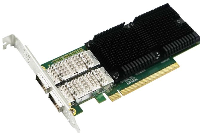
LRES1014PF-2QSFP28 是深圳市联瑞电子有限公司在 Intel 主控方案基础上开发的一款 PCI Express v4.0 x16 双光口十万兆以太网网络适配器。并辅以硬件加速数据包处理的扩展功能，同时引入了应用程序队列技术，可以通过该技术实现 Fabric TCP 的 NVMe 支持，也对 RDMA 的 iWARP 和 RoCEv2 功能具有可选择性的支持，该款适配器可以同时向下兼容 PCIe v3.0 & v2.0。
