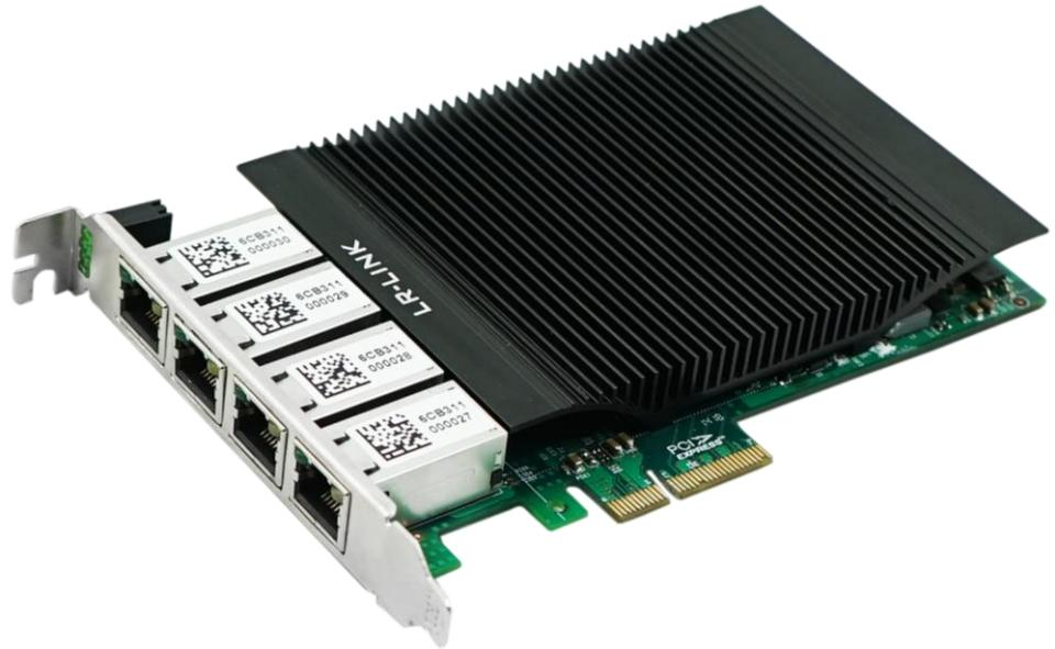
LRES2004PT-POE 是深圳市联瑞电子有限公司在基于 Intel I350 AM4 芯片方案基础上自主研发的一款四口铜缆千兆以太网 PCI Express x4 POE 以太网图像采集卡，同时兼容 PCIe x8、x16 通道。该款服务器适配卡设计主要设计应用于工业现场视觉检测服务器及设备、视觉现场客户机、快速移动以太网数据传输设备等，同时也适用于普通服务器。
