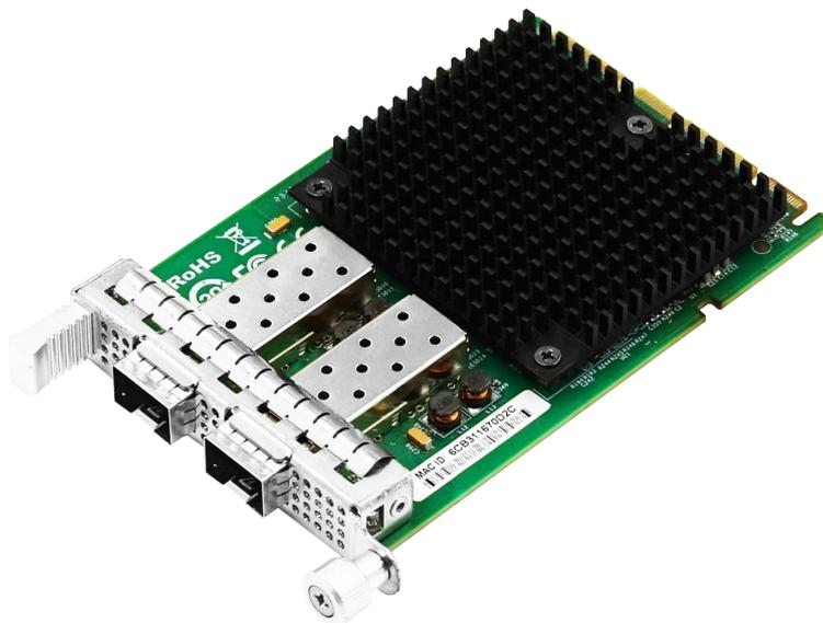
LRES3012PF-OCP 是深圳市联瑞电子有限公司在基于 Intel 主控方案基础上自主研发的一款 PCI Express v2.0 x8 OCP 3.0 万兆双口光纤以太网网络适配卡，采用的物理板尺寸符合 OCP 3.0 设计规范、小尺寸（SFF）面板。该适配卡通过为服务器和网络虚拟化技术提供的特性来满足下一代数据中心的需求。在灵活的局域网和 SAN 网络中提供可靠的性能。该适配卡在一个 PCI Express v2.0 SFF 结构上具有灵活的双口 10GbE 的链接速率。
