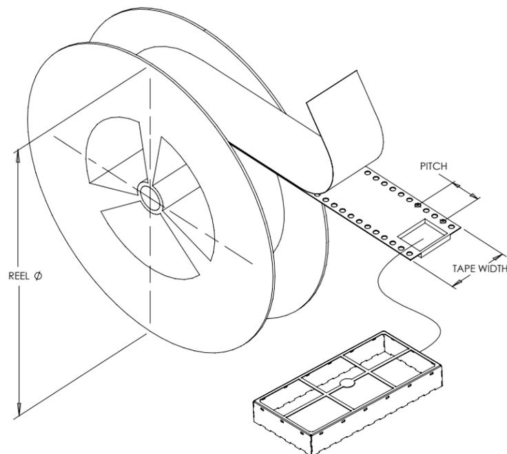
PART MARKING ON SIDES IS NOT INTENDED TO BE RELEVANT TO PART ORIENTATION IN CARRIER TAPE.
