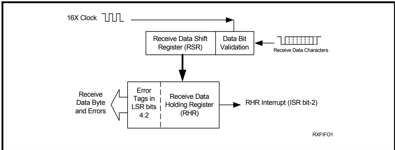
FIGURE 10. RECEIVER OPERATION IN FIFO AND AUTO RTS FLOW CONTROL MODE
